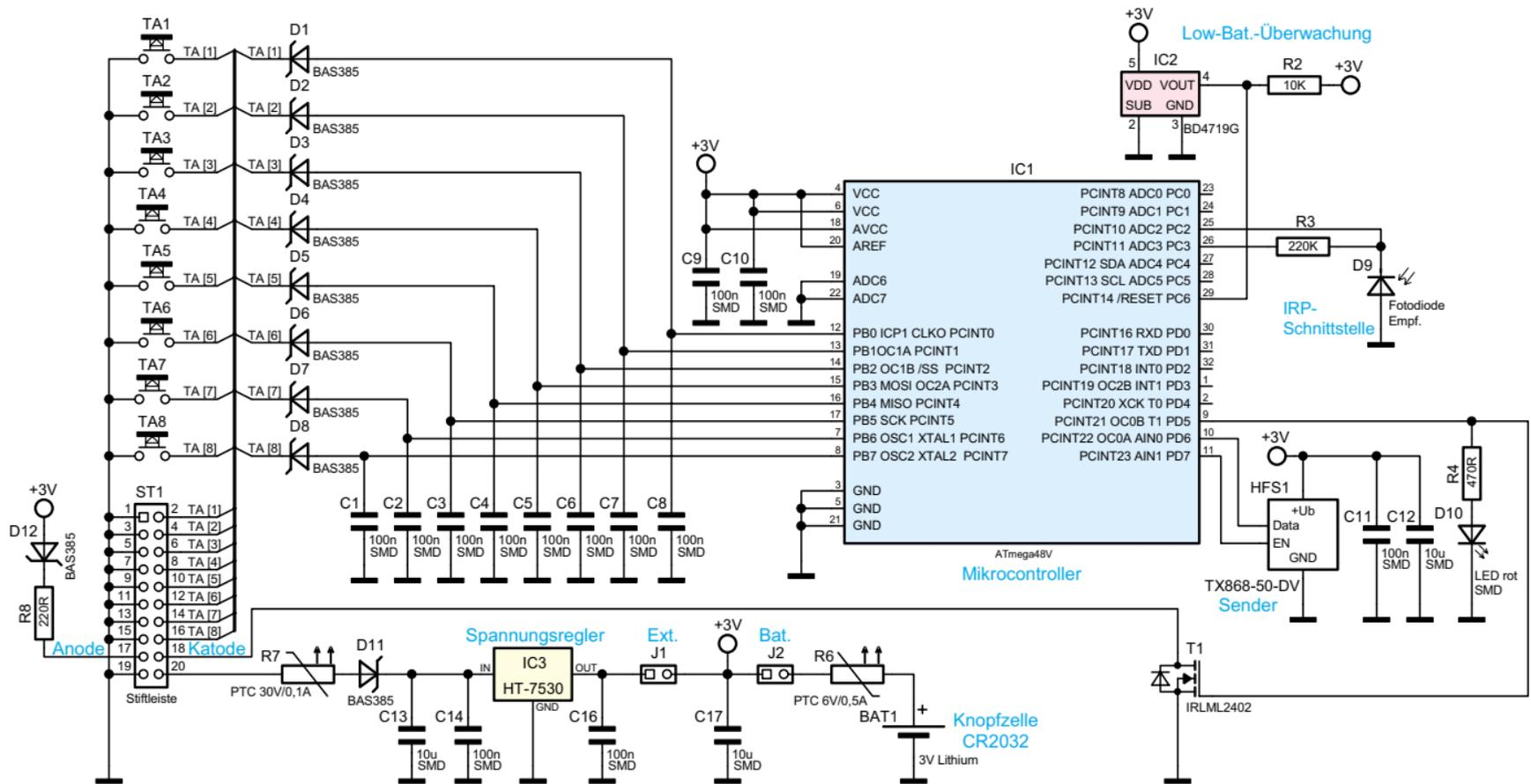
Bild 1: Schaltbild des 8-Kanal-FS20-Sendemoduls FS20 S8M
