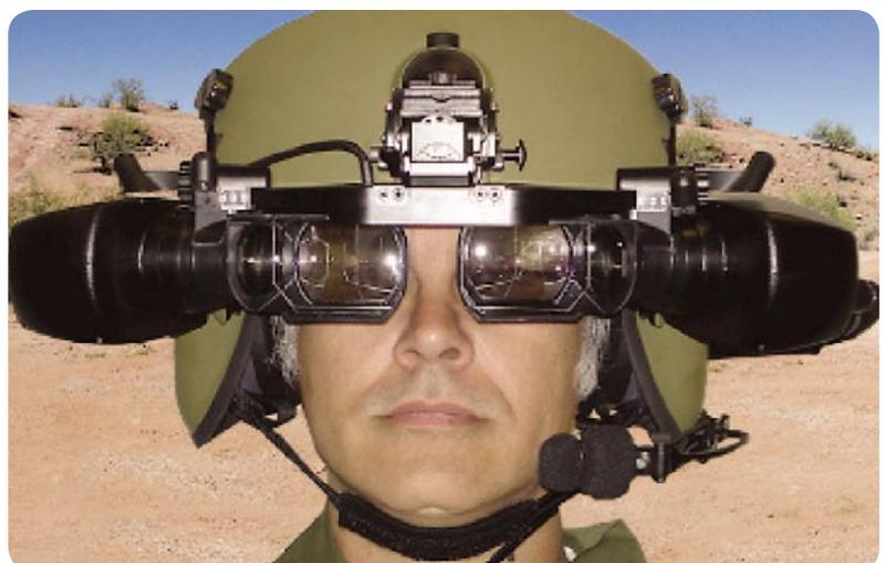
Bild 11: SimEye SX100 mit SXGA-Auflösung,  $1280 \times 1024$  Pixel: vielleicht der Traum eines Power-Gamers, aber sicher der Albtraum eines durchschnittlichen 3D-TV-Zuschauers (Quelle: Rockwell Collins)
