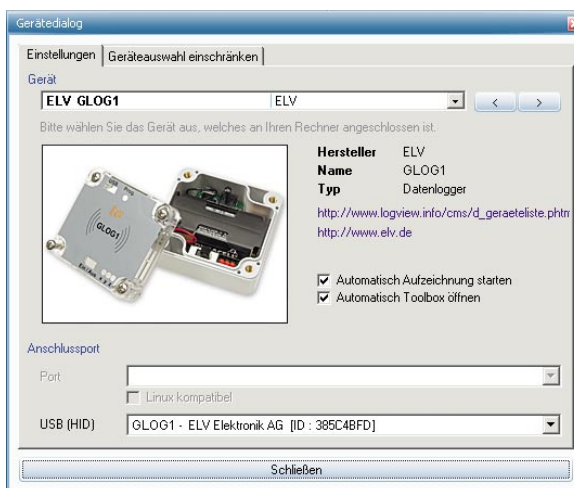
Bild 4: Mit LogView konfiguriert man den GLog1, ruft die Messdaten ab und wertet diese grafisch aus.
