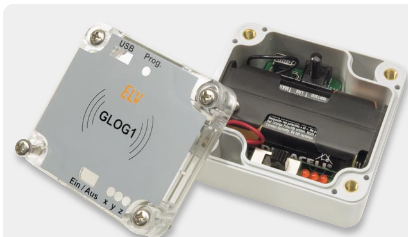
Bild 10: Der geöffnete Datenlogger mit eingesetztem Batterie-Pack
