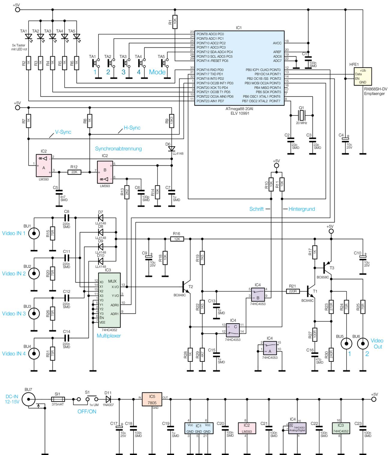
Bild 3: Schaltbild des Kamera-Umschalters
