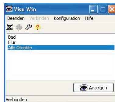
Bild 12: Das getrennt agierende Programm „VisuWin“ ermöglicht die Anzeige und Steuerung auf mehreren Rechnern im Netz.
