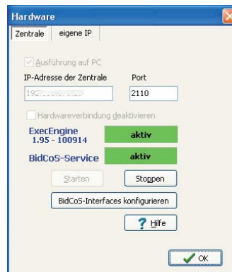
Bild 7: Die Schaltstelle für das Erreichen von Interface und Geräten – hier wird der PC als Zentrale definiert und das BidCoS-Interface konfiguriert.
