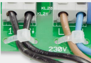
Bild 6: Mindestens so muss eine Leitungsführung auf der Platine aussehen. Die Kabelbinder verhindern, dass eine gelöste Leitung im Gerät „vagabundiert“.
