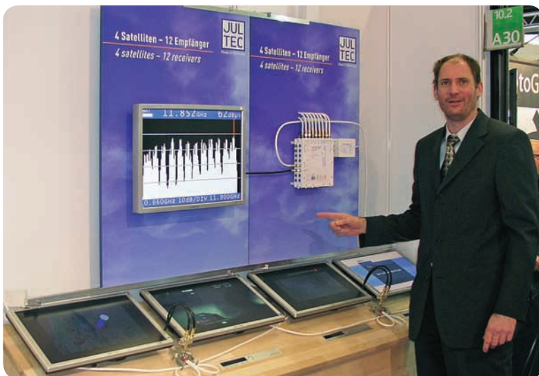
Bild 5: State of the Art: Diese teilnehmergesteuerte Einkabellösung (JESS-Multischalter) kann über zwei Stammlösungen jeweils zwölf Teilnehmer mit allen Programmen von vier Satelliten versorgen.
