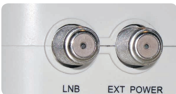
Bild 3: Über die F-Buchse „EXT POWER“ ist Fremdspeisung des Sat-Navi aus Multischalter oder Receiver möglich, wodurch die eingelegten Batterien geschont werden.
