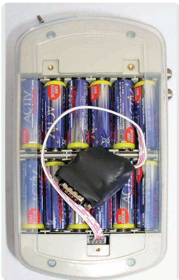
Bild 2: Zwölf Mignonzellen (AA-Typ) machen das SZU 21-00 je nach Qualität für drei bis fünf Stunden autark. Damit lassen sich viele Antennen ausrichten.
