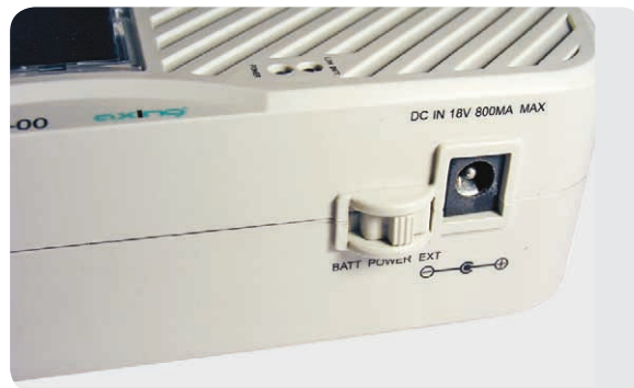
Bild 4: Eine rote Leuchtdiode „LOW BATT“ zeigt das bevorstehende Ende der Batterielebensdauer an, ein grüne den aktiven Status des SZU 21-00. An der Seite ein geschützter Wahlschalter zur Wahl zwischen der Stromversorgungsart (Batterien oder Multischalter/Receiver) und eine DC-Buchse.
