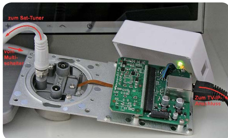
Bild 9: Nur eine Unterputzmontagedose ist für die Antennensteckdose (Unterputz) und das IP-Modul (Aufputz) erforderlich.
