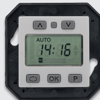
Bild 5: Kann als Rollladensteuerung oder allgemein als Zeitschaltuhr im System eingesetzt werden: die Rollladensteuerung
