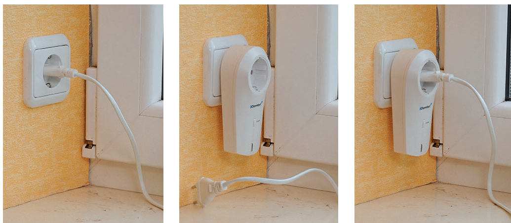
Bild 3: Drei Handgriffe, und der Zwischenstecker-Aktor ist installiert.
