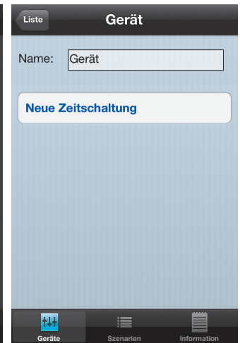
Bild 11: ... bis das Gerät erkannt ist, dem nun ein Name und bei Bedarf Schaltzeiten zugeordnet werden können.
