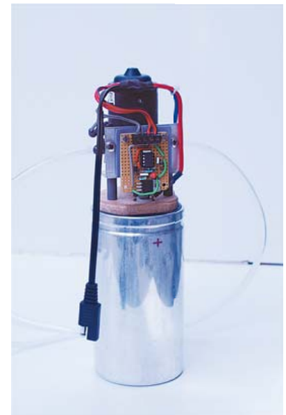
Bild 7. Die Schaltung aus Bild 6, aufgebaut mit einem MOSFET IRF3708 und einem 0,15-F-Elko, versorgt die Pumpe auf der Rückseite. Das Kabel (links) stellt die Verbindung zum Solarpanel her.
