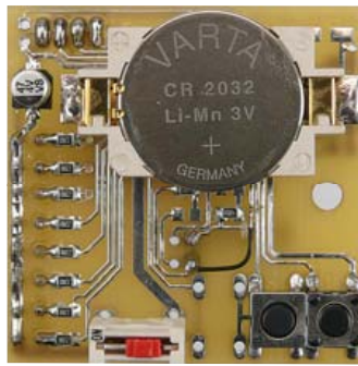
Bild 4. Platinenunterseite mit Knopfzelle, Entkoppel-Elko, Einschalter und zwei Tastern zur Bedienung, über die auch eine Texteingabe möglich ist.
