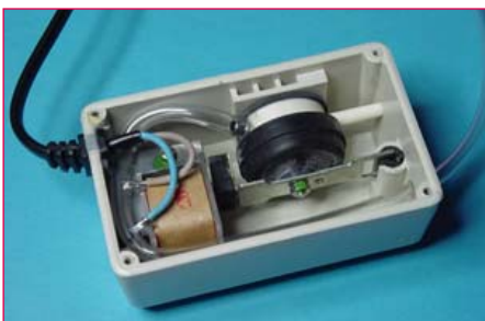
Bild 9. Die Pumpe mit montiertem Ansaugstutzen.
