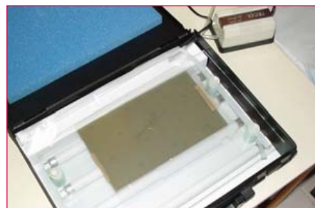
Bild 10. Die Belichtung kann nun mit Unterdruck stattfinden.
