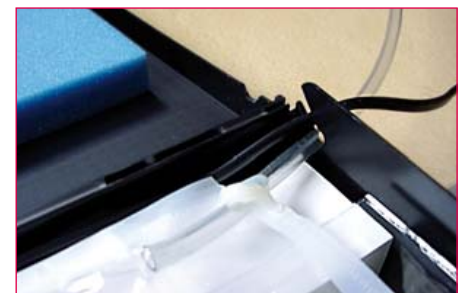
Bild 11. Hier wird der Schlauch für die Luftabsaugung durchgeführt.
