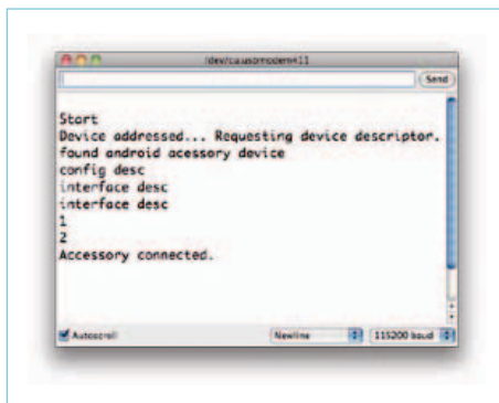
Bild 3. Screenshot des Serial Port Monitor bei der Verbindung eines Android-Geräts mit dem Arduino Mega ADK.
