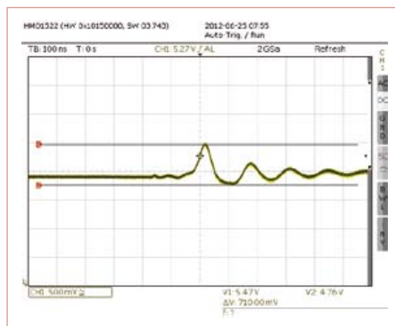
Bild 6. Verlauf der Ausgangsspannung bei impulsförmiger Laständerung.
