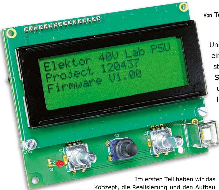
Unser Labornetzgerät VariLab 402 wird von einem Mikrocontroller gesteuert, er unterstützt den Benutzer beim Einstellen von Spannungen und Strömen. Außerdem überwacht der Mikrocontroller systemrelevante Größen und sorgt für die Sicherheit. Mess- und Einstellwerte werden auf einem vierzeiligen LC-Display ausgegeben, für die Weiterverarbeitung ist eine USB-Schnittstelle vorhanden.
