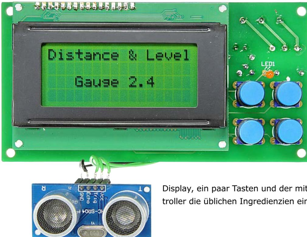
Kleine, gut erhältliche und spottbillige Ultraschallsensoren ermöglichen den Entwurf von einfachen bis luxuriösen Messgeräten für Entfernungen aller Art. Neben dem Modul sind ein
