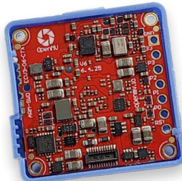
▲ Bild 3b. Rückseite des Boards. Eine Stiftleiste könnte leicht an die GPIO-Reihe auf der rechten Seite gelötet werden.
