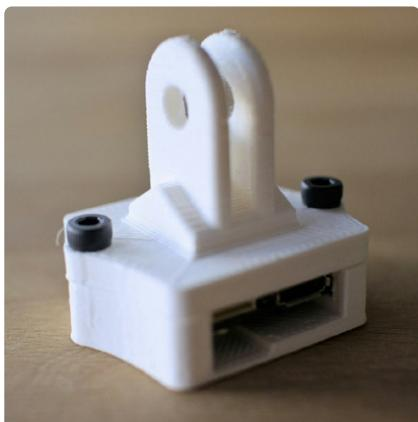
Bild 2. 3D-gedrucktes Gehäuse zum Schutz der Nicla-Vision-Platine.
