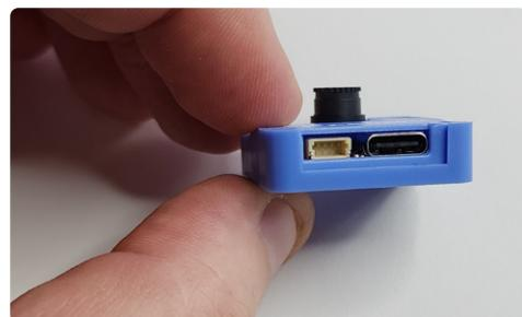
▲ Bild 2c. Unterseite, zeigt die QWIC- und USB-C-Anschlüsse.
