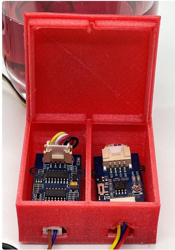
Bild 4. Leiterplatten in das 3D-gedruckte Gehäuse eingesetzt.
