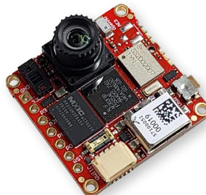
▲ Bild 3a. Ohne Gehäuse ist die Technik im Inneren sichtbar, einschließlich des E3-Dual-Core-Mikrocontrollers von Alif Ensemble in der Mitte. Der USB-C-Anschluss (unter dem QR-Code) verdeutlicht nochmals, wie winzig der Chip ist (6 × 7 mm).
