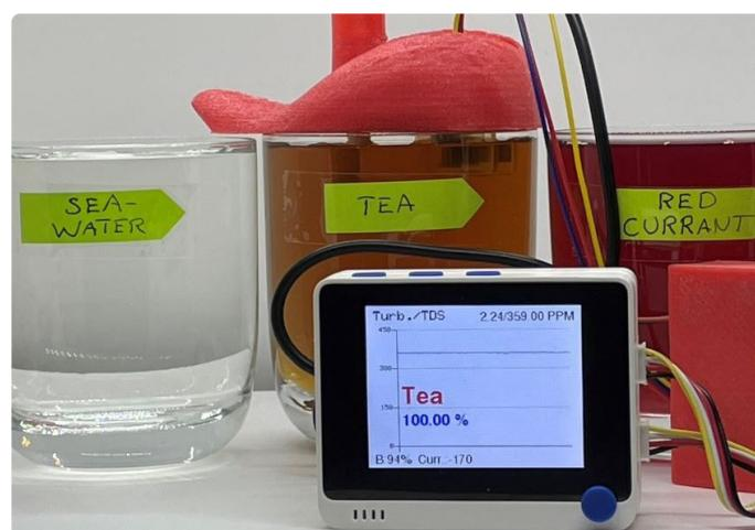
Bild 2. 3D-gedruckte „Zungen“-Baugruppe zur Halterung der Sensoren in gleichmäßiger Tiefe.
