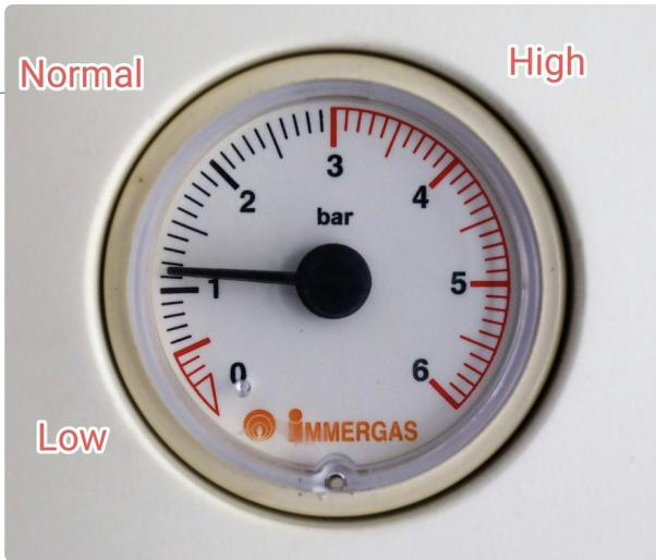
Bild 5. Druckbereiche des Messgeräts: niedrig, normal und hoch.
