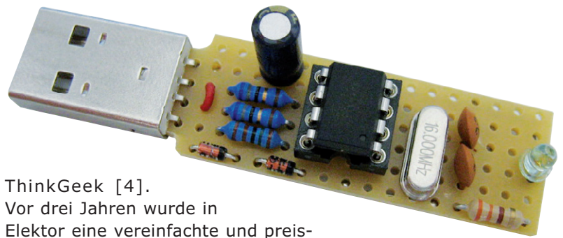
Bild 2. Der USB-Keyboard-Stick passt gut auf ein Stück Lochrasterplatine.
