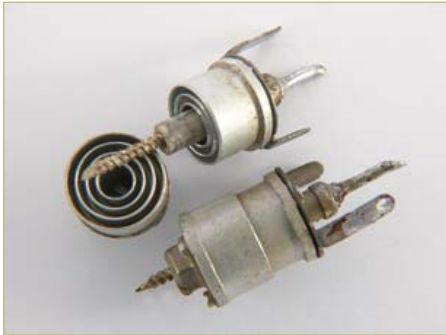
(a) „Bienenkorb“-Trimmer von Philips. Geringe Verluste. Geniale Konstruktion ermöglicht hohe Linearität über den gesamten Bereich. Einstellbar im Bereich von 5...30 pF .
