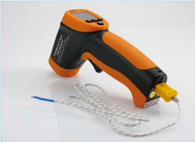
Bild 6. Einigen Geräten liegt ein Thermo-Kontaktsensor Typ K bei, so dass der Emissionsgrad des Messobjekts bestimmt werden kann.
