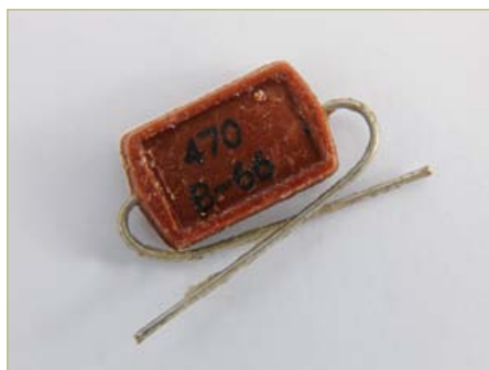
(h) Glimmer-Kondensator. Arbeitsspannung 500 V (1966 NOS). Mit 470 pF .
