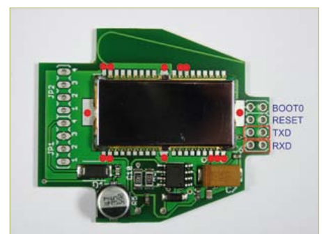
Bild 10. Hier sind die beim Bluetoothmodul zu löten Pins zu sehen. Alle anderen Pins werden nicht benötigt.
