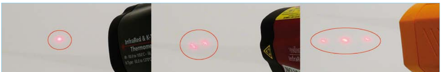
Bild 5. Zur Messfeldabgrenzung sind in den Geräten ein, zwei oder sogar drei Laser eingebaut.
