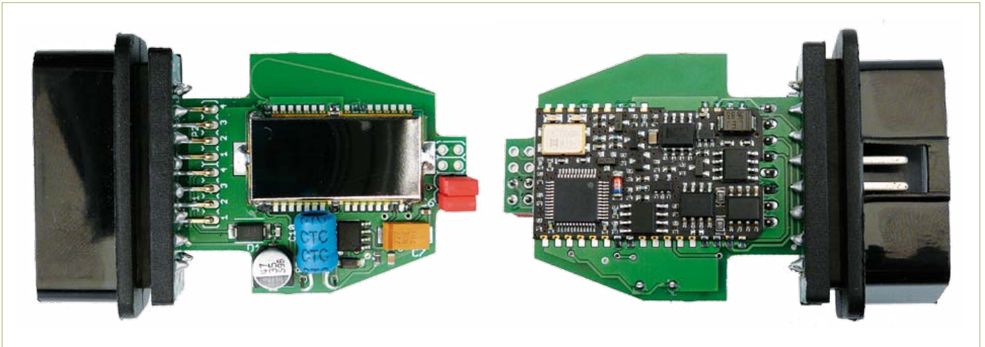
Bild 3. Ober- und Unterseite der Bluetooth-Interface-Platine mit angelötetem OBD-Stecker.
