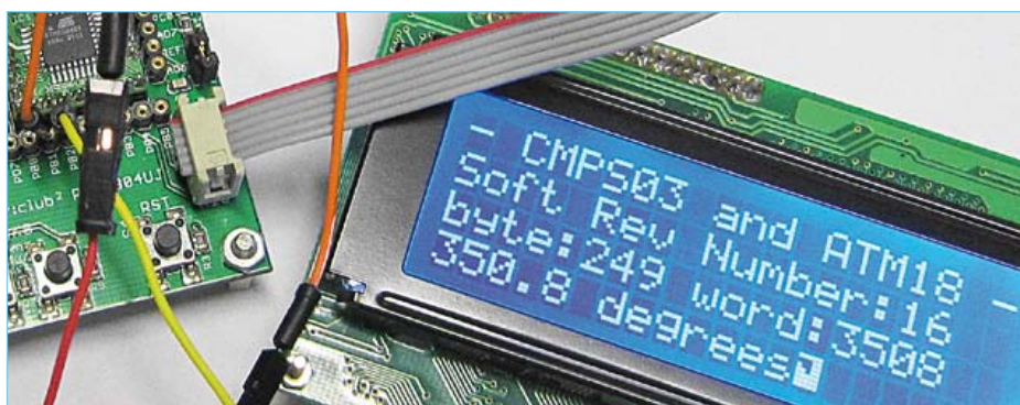
Bild 2. Das Display zeigt das Messergebnis und Systeminformationen.
