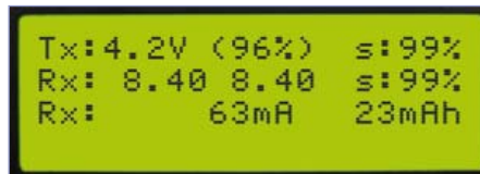
Bild 4. So sieht das Display bei einer Versorgung des Senders mit 4,2 V und des Empfängers mit zwei 8,4-V-Akkus aus.
