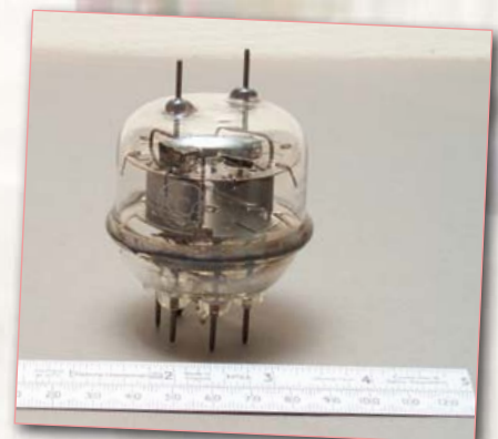
Die 832-A ist eine früher bei Funkamateuren beliebte Send-Doppeltetrode. Sie war im Gegensatz zur europäischen QQE06/40 (siehe Retronik 12/2008) nicht neutralisiert.
