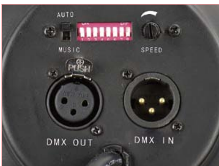
Bild 6. DMX-Ein- und Ausgang auf der Rückseite des RGB-LED-Scheinwerfers. Die DIP-Schalter dienen im DMX-Betrieb zur Einstellung des DMX-Kanals.
