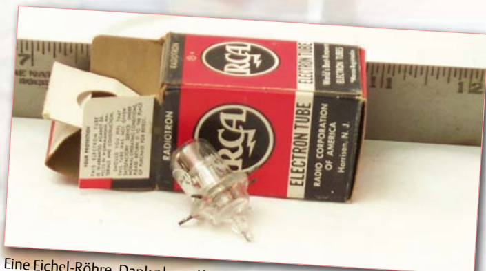
Röhren aus den 1930ern wie die eine links hatten 4, 5, 6, oder 7 Anschlüsse in den unterschiedlichsten Abmessungen. Dann kamen der Oktal-Sockel, 9- und 7-polige Miniaturtypen sowie das 12-polige Compactron und Subminiaturtypen.
