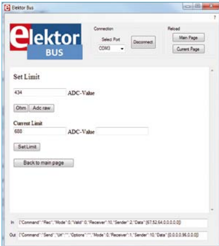
Bild 7. Grenzwert-Überwachung: Alles ist plattformunabhängig in HTML und Javascript realisiert.
