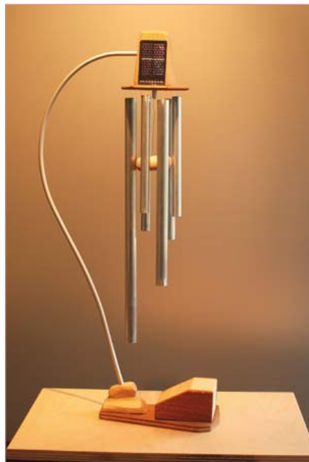
Bild 3. Ein Glockenspiel als akustischer Kondensator-ist-voll-Melder.
