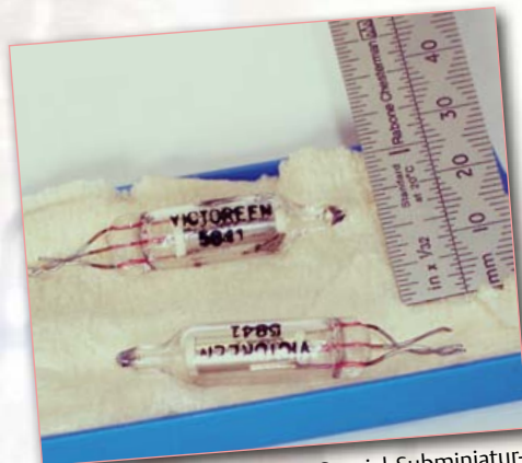
Die Victoreen 5841 ist eine Spezial-Subminiatur-Hochspannungs-Regler-Röhre. Sie stellt einen Strom von 5...100 \mu A bei 900 V zur Verfügung.
