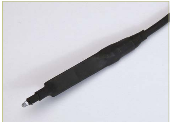
Bild 1. Die Sensorplatine in der Messspitze stellt einen Temperaturfühler mit SPI-Ausgang dar.
