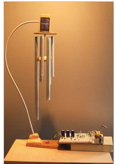
Bild 3. Ein Glockenspiel als akustischer Kondensator-ist-voll-Melder.
