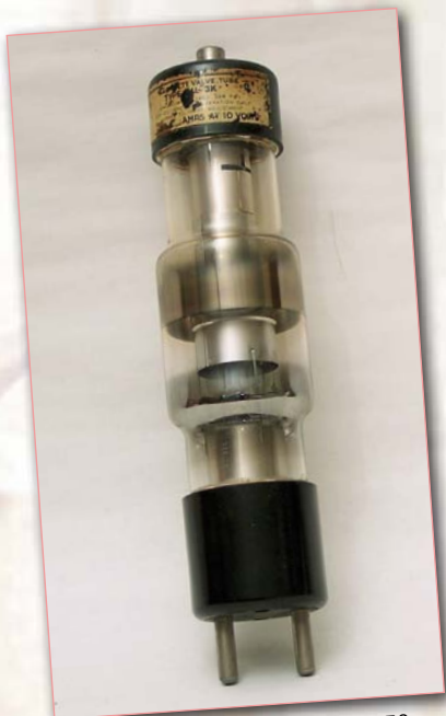
Diese Röntgen-Röhre aus den 1950ern ist gut 30 cm lang und verwendet eine feststehende Anode und Kathode. Moderne Röntgen-Röhren arbeiten mit rotierenden Anoden.
