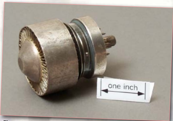
Eine Leistungs-Sende-Tetrode 4X150. Die metallische Anode hat Kühlrippen zur Zwangskühlung. Seinerzeit ein sehr verbreiteter Typ – praktisch jeder Funkamateurlatte hatte so eine Röhre.
