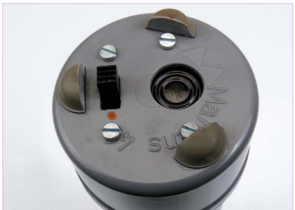
Bild 4. Der Schalter und der Lautsprecher sind im Rohrstopfen montiert.
