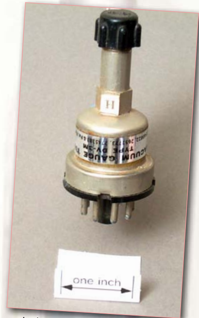
In dieser Röhre steckt neben der Heizung ein Thermoelement, mit dem man eine vom Vakuum abhängige Spannung erhält. Oben sieht man den 1/8"-Anschluss.
