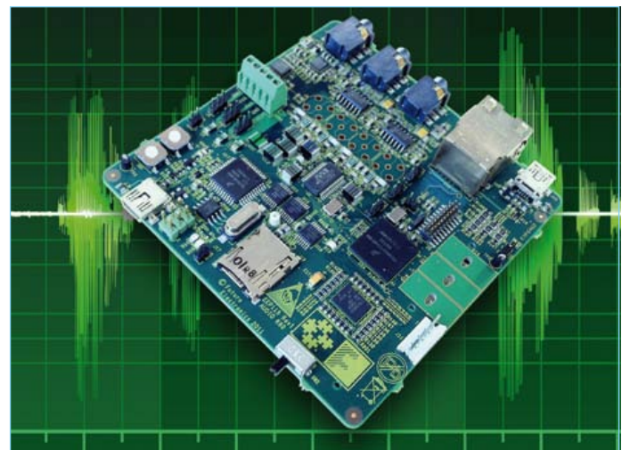
Bild 1. Das Audio-Streaming-Board von Future Electronics basiert auf einem Freescale Kinetis K60 mit einem ARM-Kern Cortex-M4.
