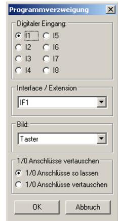
**Hinweis:** Wenn du einen Minitaster als Schließer am Anschluss 1 und 3 des Tasters anschließt, geht die Programmverzweigung zum 1 Zweig wenn der Schalter gedrückt ist, sonst zum 0 Zweig.
