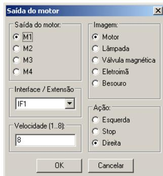
conectada à saída do motor (ver dica em saída de lâmpada ), essa pode ser ligada e desligada.
