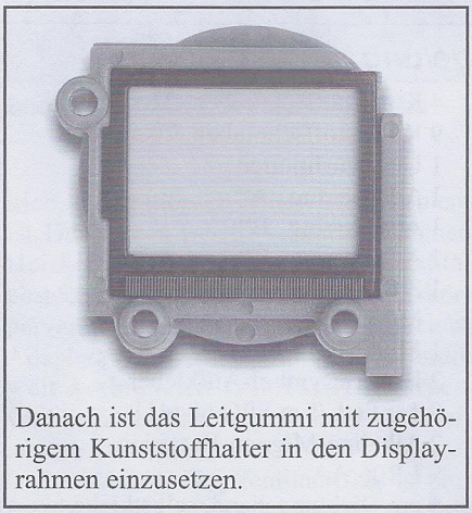
Einsetzen des Leitgummistreifens mit Halterahmen
