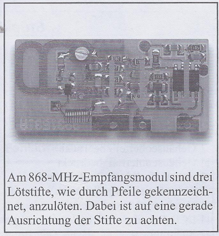
Das Empfangsmodul wird zuerst mit 3 Lötstiften bestückt.
