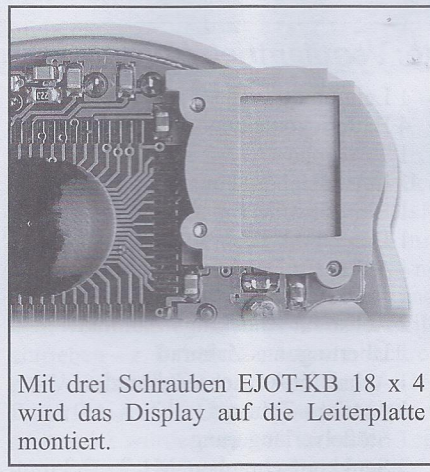
Montage der Displayeinheit auf der Leiterplatte
