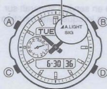
Une DEL (diode électroluminescente) éclaire l'afficheur de la montre pour qu'il soit mieux visible à l'obscurité. Le commutateur d'éclairage auto de la montre s'active lorsque vous tournez la montre vers votre visage, et à ce moment l'afficheur s'éclaire.
