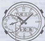
Indicador de energía de la pila
